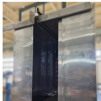
Autopesun imuaukon leveyttä säädellään liukuovilla
